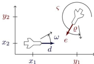
$$\begin{cases} x_1' = -v_1 + v_2 \cos \vartheta + \omega x_2 \\ x_2' = v_2 \sin \vartheta - \omega x_1 \\ \vartheta' = \varpi - \omega \end{cases}$$
